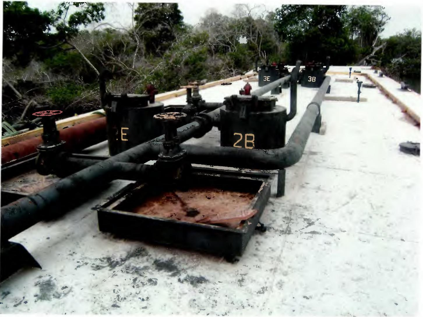
En esta Fotografía se aprecia la cubierta de La Barcaza JULIANA, sobre la cual, está el Tubo Múltiple para cargue y descargue, de los Líquidos, mediante la combinación de sus Válvulas de Compuerta, que seleccionan los Tanques en operación.
