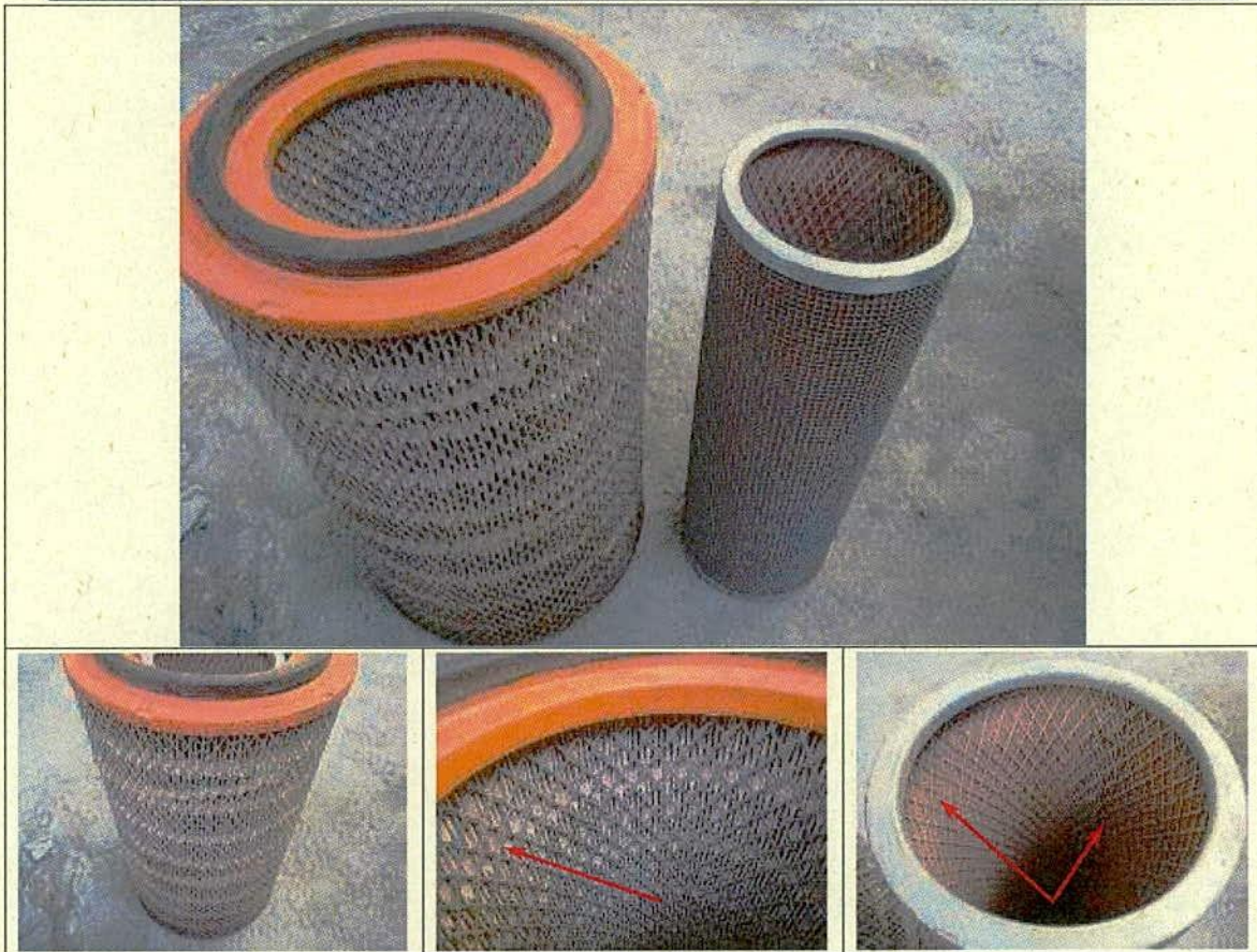
Fotografía No.2: Se encuentra que los filtros de aire no se sentaron bien en la carcasa y que además se manipularon, por lo cual se observa tierra del lado limpio de los filtros.
