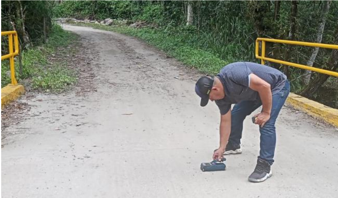
Foto No.15 ensayos de ferros scanner en tablero o placa del puente.
