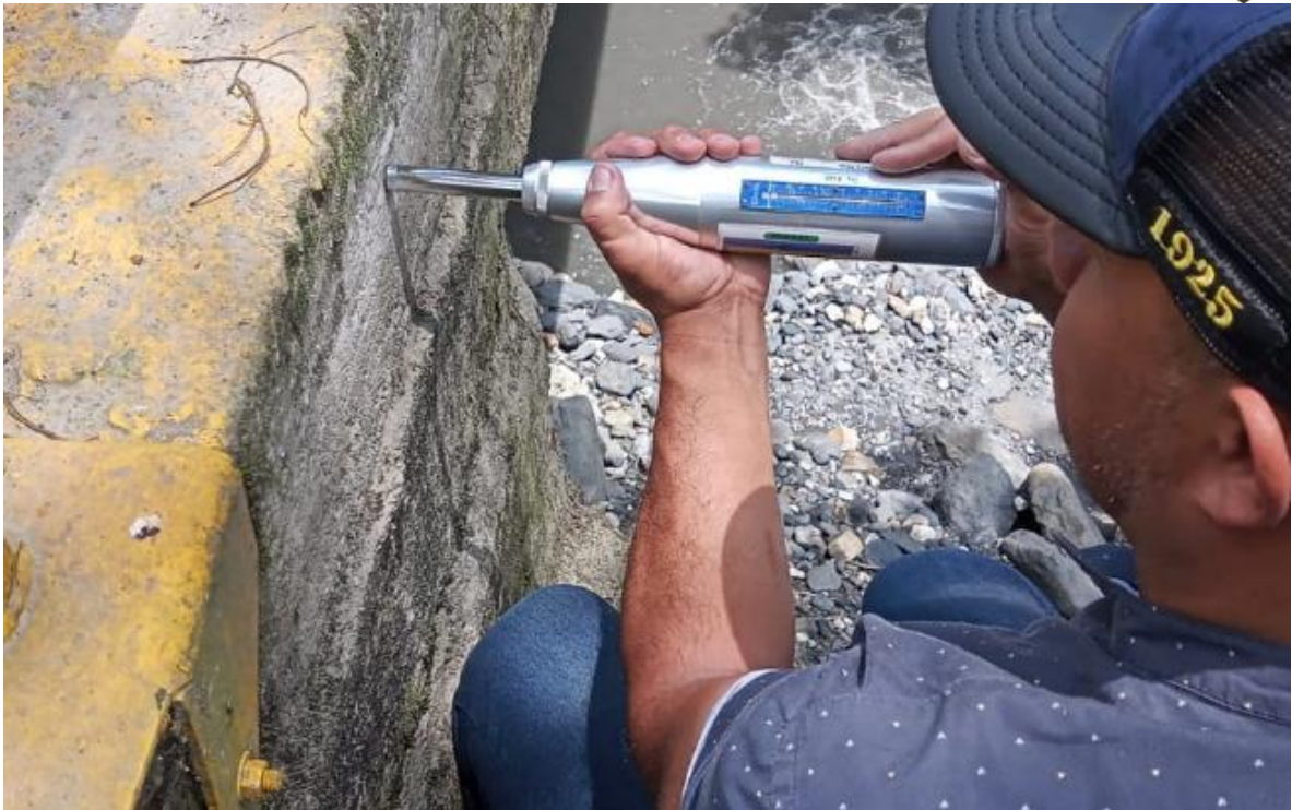
Foto No.17 ensayos de esclerometria en viga costado occidente.
