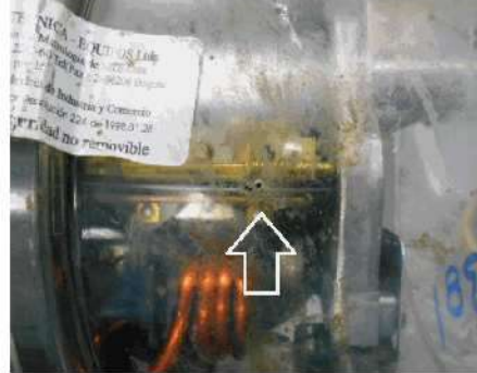
TAPA PRINCIPAL PERFORADO (Una perforación en la parte izquierda a la altura del disco)
