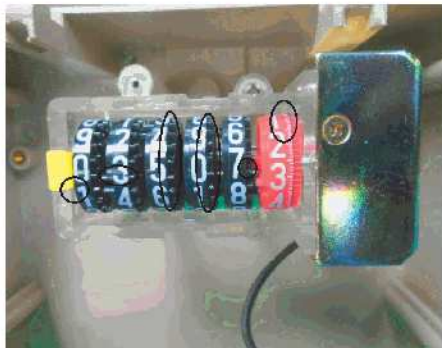
REGISTRADOR FISURADO (Rayado el numerador decimal, unidades, decenas, centenas, unidades de mil y decenas de mil)
