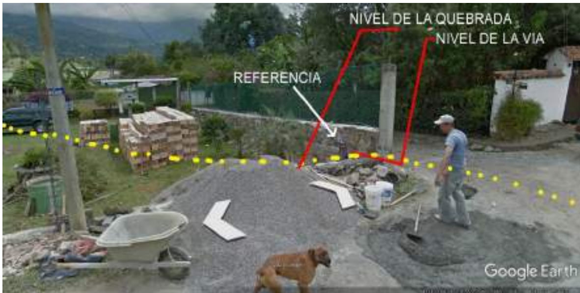
Imagen 4: Diferencia de nivel de la vía con el cauce natural GE streetView Enero 2013
