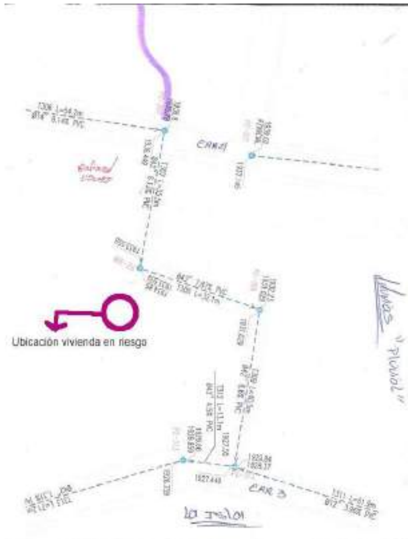
Imagen 6: Diseño de detalle del alcantarillado pluvial por donde pretenden canalizar además la quebrada Cucuaté
