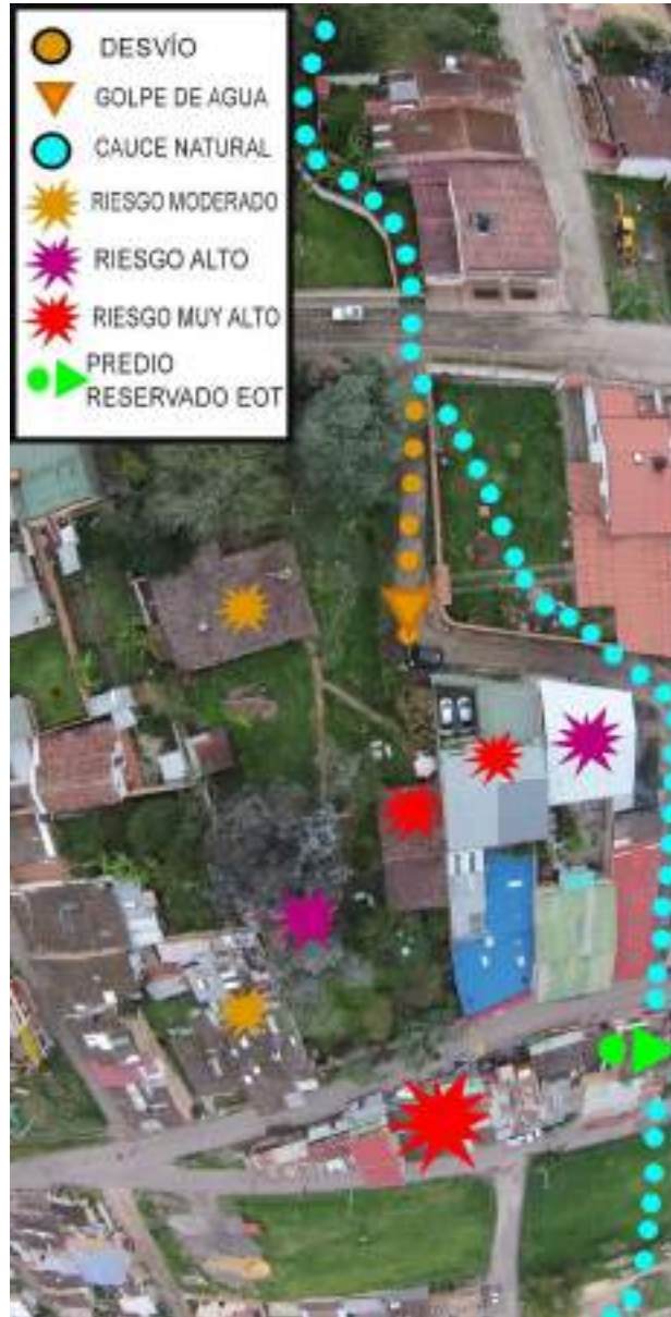
Imagen 9: Estimación de riesgos derivados del desvío ilegal y la futura obra de canalizar en alcantarillado pluvial la quebrada.
