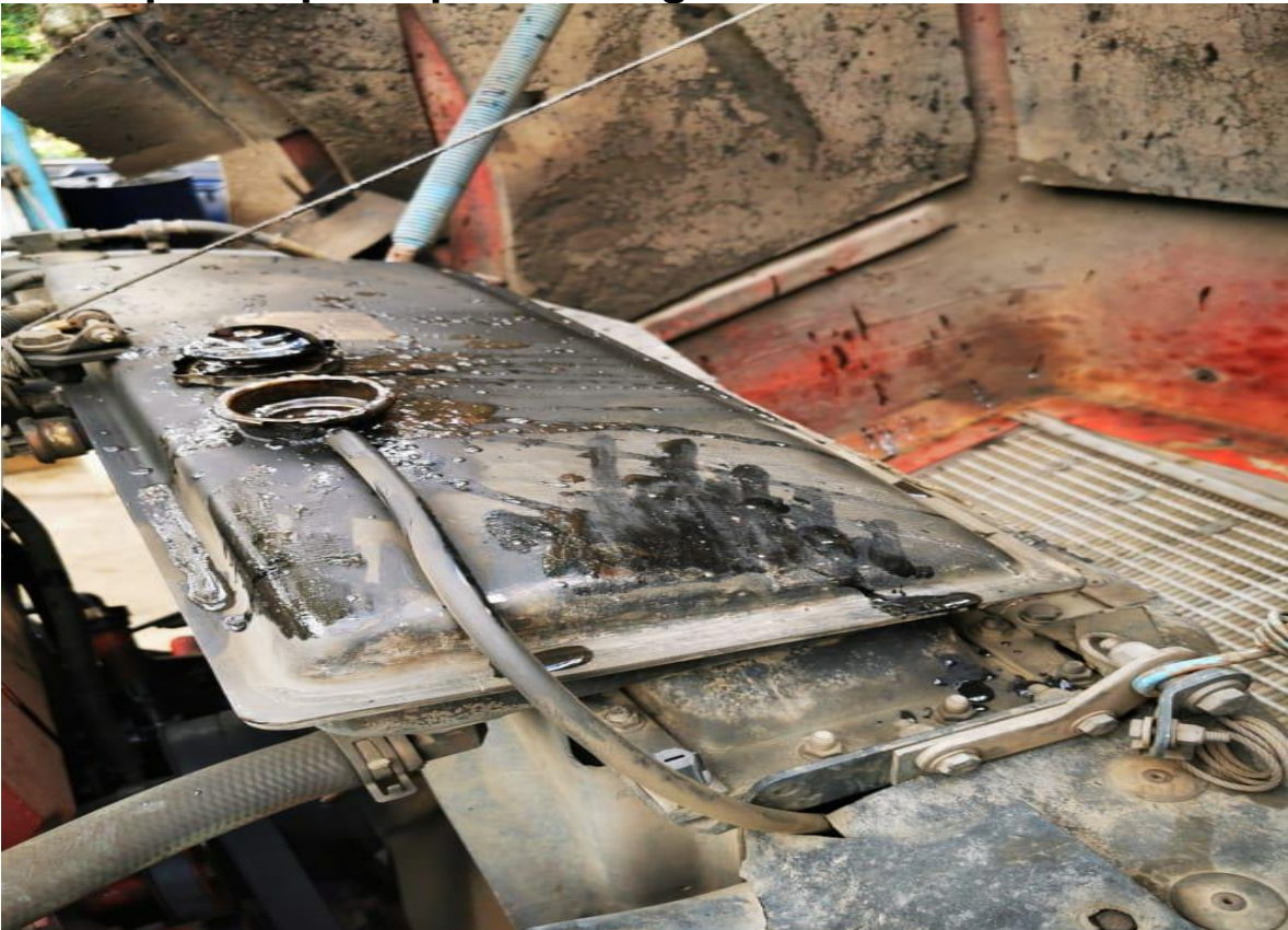
Motor para reparar pasando agua al aceite
